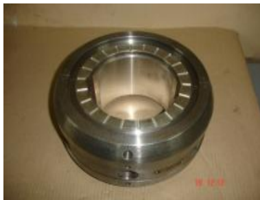
FAN BLOWER BEARING
